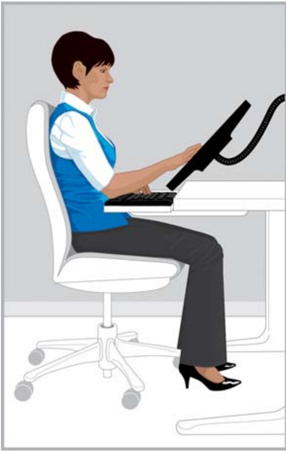
לא נכון הושטת הזרוע למלוא אורכה לביצוע פעולות במגע עשויה לעייף במהירות את הכתף ואת הזרוע.
